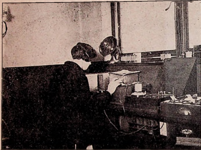
Fig. 2. Meten der zelfinducties van de afgeschermden spoelen; met de schakelaars op dezelfde tafel, waarop men de spoel ziet staan, worden de verschillende wikkelingen ingeschakeld.
